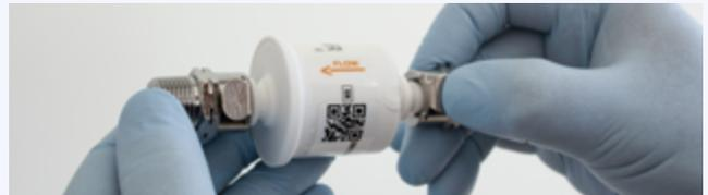
5. Schnellverschlusskupplungen und neuen Filter an den Verbindungsenden mit einem geeigneten Desinfektionsmittel desinfizieren. Neuen Filter auf die Schnellverschlusskupplung aufstecken, bis dieser an beiden Enden fest einrastet.
