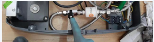
4. Entriegelungsvorrichtung der Schnellverschlusskupplung drücken und das Filtergehäuse von beiden Adaptern nacheinander abziehen.
