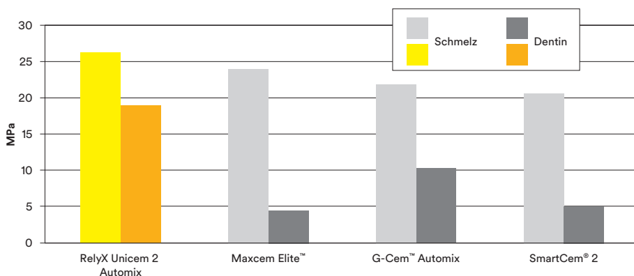
Scherhaftung nach 24 Stunden, lichtgehärtete Materialien. Quelle: 3M interne Daten. Daten auf Anfrage bei 3M erhältlich. Kontaktinformationen siehe Rückseite.
