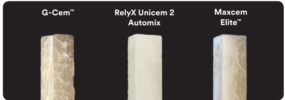
Ergebnisse von Belastungstests bei selbstadhäsiven Composite-Zementen. Alle Prüfmuster waren selbstgehärtet und durchliefen während der Wasserlagerung 10 000 Zyklen einer thermischen Wechselbelastung. 3M interne Daten. Daten auf Anfrage bei 3M erhältlich. Kontaktinformationen siehe Rückseite.
